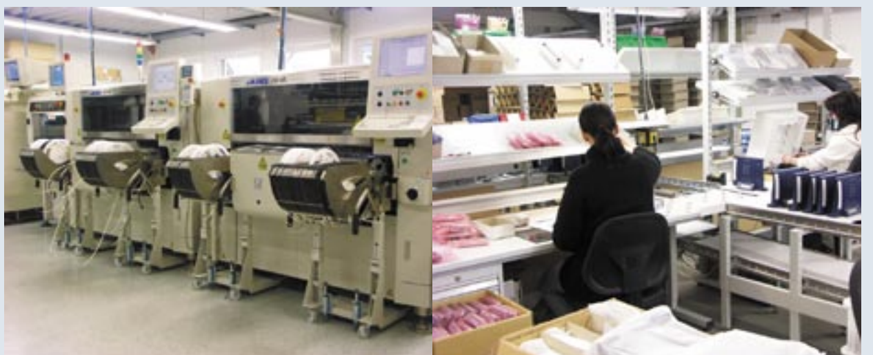
In den vergrößerten Fertigungsräumen am Standort Cremlingen werden die Auerswald Systemtelefone mit Hilfe modernster Bestückungsautomaten und hochmotivierter Mitarbeiter gefertigt.
